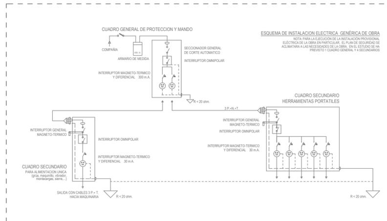
ESQUEMA DE INSTALACIÓN ELÉCTRICA EN OBRA
